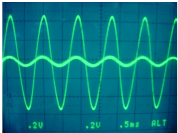
Figura 11: Salida diferencial ( V_{out+} ) en el filtro para una señal de entrada con frecuencia mayor que la frecuencia f_c = 125.5\text{Hz} .
