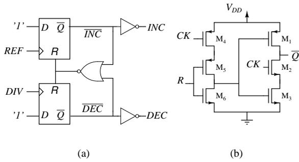
Fig. 6. (a) Esquemático del PFD. (b) Flip-flop usado en el PFD.
